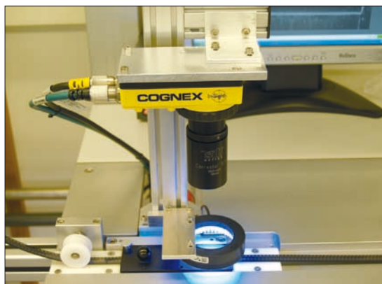
Obr. 1. Kontrola čipů SMD obsahujících krystaly do hodinek
