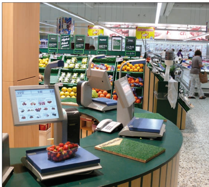
Obr. 1. Nová váha pro samoobslužný prodej s automatickým rozpoznáváním druhu zboží (foto: Fraunhofer IITB)
