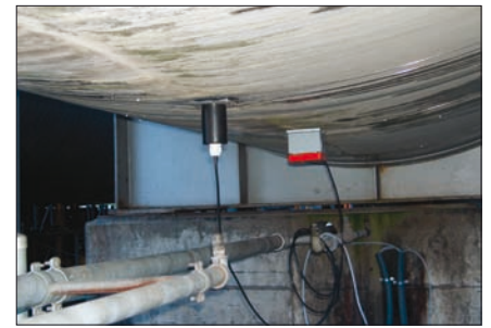
Obr. 3. Měření maximální hladiny při plnění nádrže
