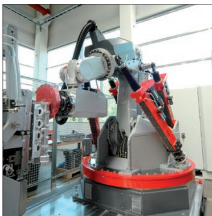
Obr. 1. Stroj Robmill: vyšší výkon při výrazně nižších nákladech; šestiosý robot s kloubovým ramenem umožňuje dosud nepoznanou flexibilitu
