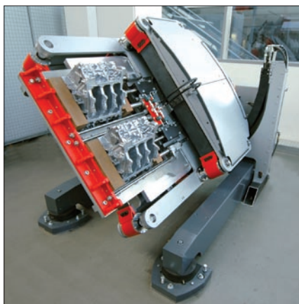
Obr. 2. Ve stroji Swingmaster sm 315 byla pro minimalizaci opotřebení mechanická převodovka nahrazena elektronickým ekvivalentem; to bylo možné jen díky použití pohonů Acopos v kombinaci s protokolem Ethernet Powerlink
