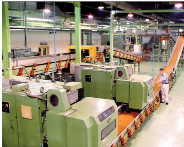
Obr. 7. Xuzhou Tobacco Factory v Číně dává před „natvrdo“ naprogramovanými komunikačními vazbami přednost jejich pružnému grafickému konfigurování v prostředí Profinet CBA
