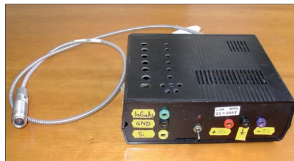
Obr. 7. Prototyp dvoupásmového pyrometru systému Si/InGaAs
