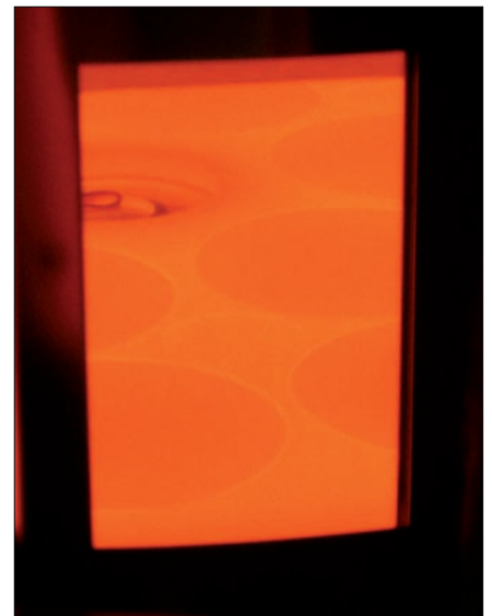
Obr. 3. Pohled do komory reaktoru na susceptor s křemíkovými deskami
