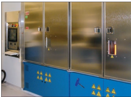
Obr. 1. Pohled na epitaxní reaktor
