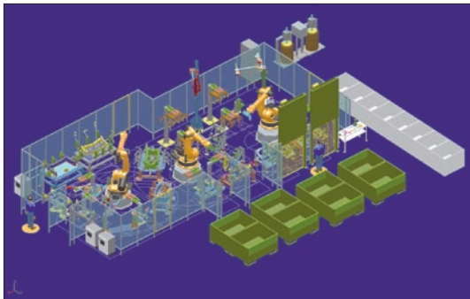
Obr. 2. Ilustrace virtuálního návrhu linky svařovny ( Process Designer )
