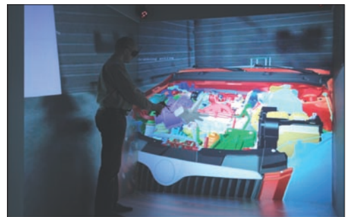
Obr. 3. Práce s DMU/CAVE ve Škoda Auto a. s. - zástavba motorového prostoru
