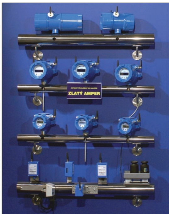
Obr. 4. Hardware komplexního bezdrátového bateriového systému SCT-Telemetry na veletrhu Amper 2008 (zdroj: Soft & Control Technology)
