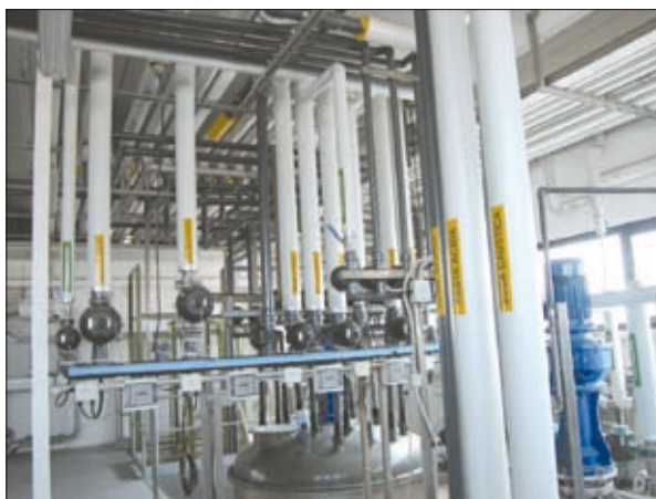
Obr. 2. Automatické dávkování přísad do homogenizátoru
