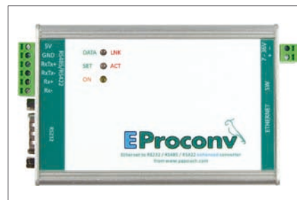
Obr. 3. Malý komunikační procesor eProconv
