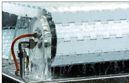
Obr. 4. Spolehlivě jsou čištěna i čela pohonu
