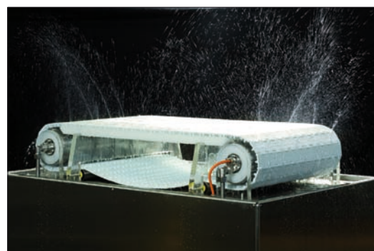
Obr. 3. Po stanovené době působení je čistící pěna opláchnuta
