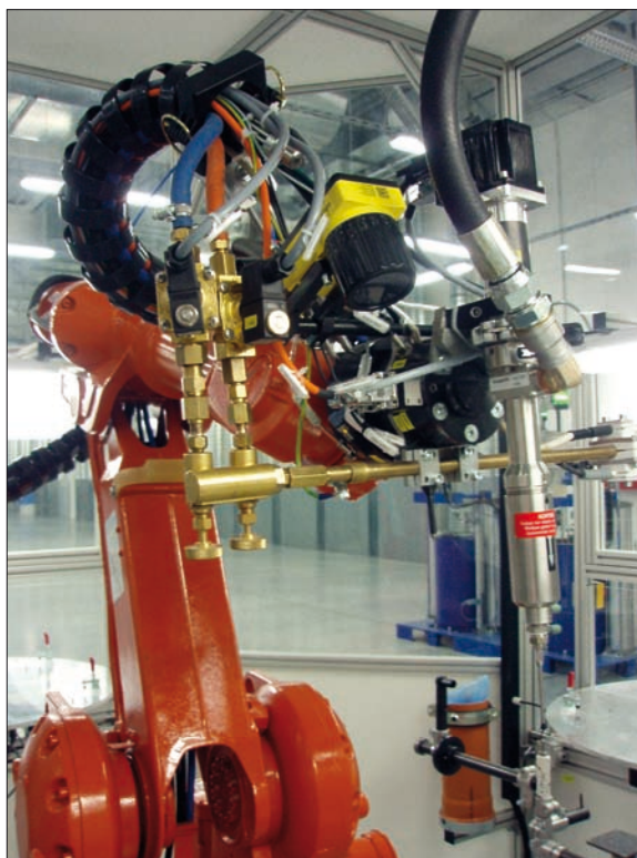
Obr. 3. Pohľad na nástrojovú hlavu zľava – kamera Cognex, horák a dávkovacia dýza Viscotec
