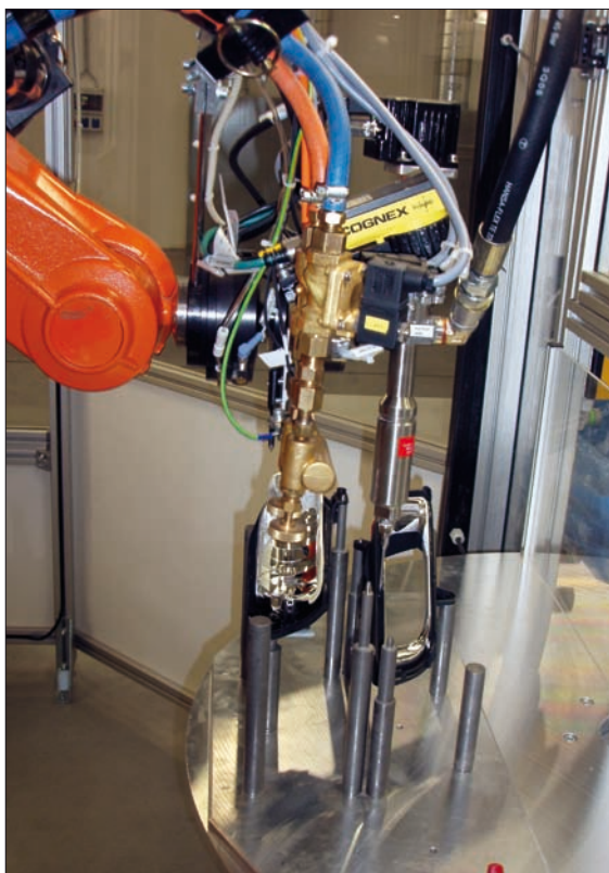
Obr. 2. Nanášanie lepidla na okraj dielu svetlometu
