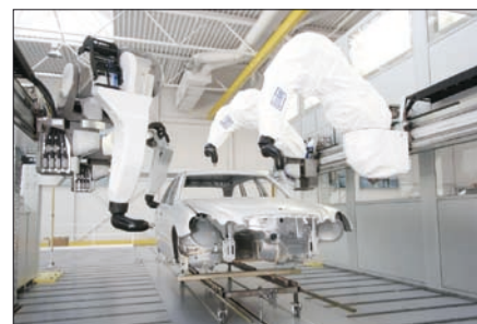
Obr. 2. Roboty EcoRP E32 (výrobce Dürr Paint System) určené pro lakovny využívající bezpečnostní PLC GuardLogix
