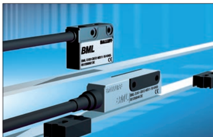
Obr. 4. Magnetický snímač délky BML s rozlišením do 1 \mu\text{m} a přesností \pm 10 \mu\text{m} (Balluff)
