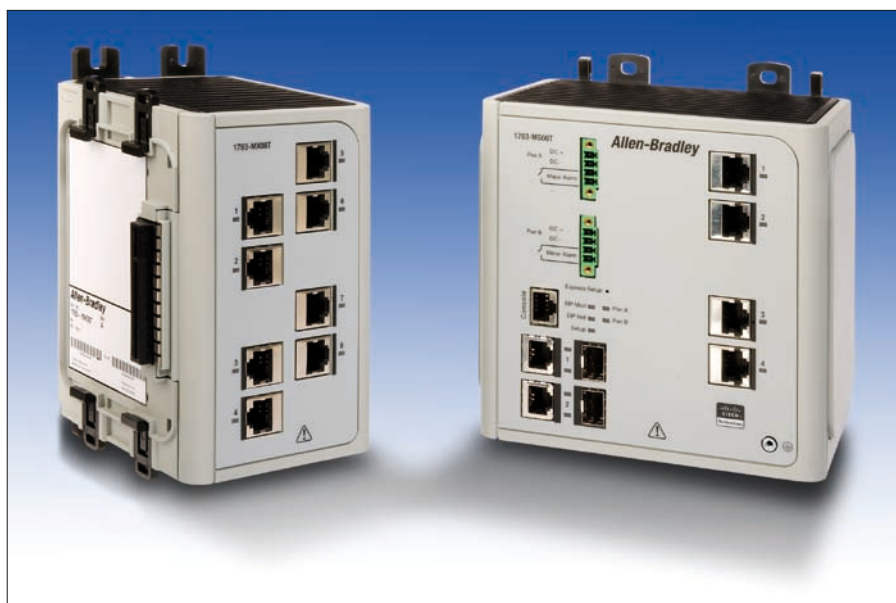
Obr. 1. Modulární řízené síťové přepínače, které byly vyvinuty ve spolupráci firem Rockwell Automation a Cisco
