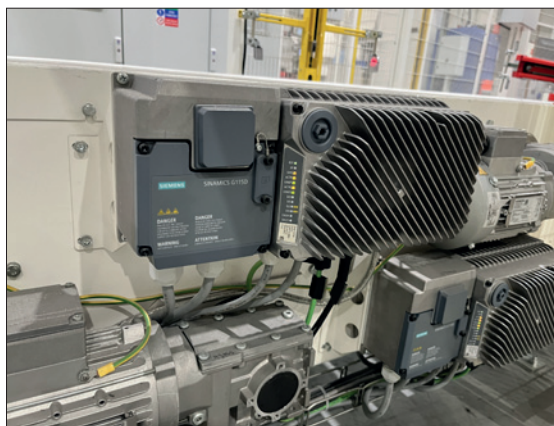
Obr. 5. Decentralizované měniče Sinamics G115D na dopravníku
