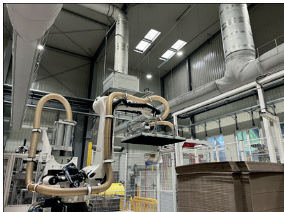
Obr. 3. Robot Kuka Quantec s vakuovým uchopovačem a výkonnou vývěvou na první ose
