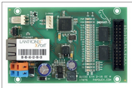
Obr. 2. Modul Quido s 30 vstupy, dvěma výstupy (relé) a rozhraním Ethernet
