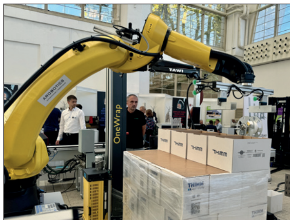
Obr. 4. Ovinovací stroj OneWrap LP je klasickým představitelem stacionárních ovinovacích strojů s funkcí pre-stretch (dodavatel: Servisbal)
