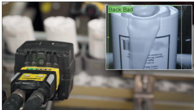
Obr. 2. Systémy strojového vidění s využitím umělé inteligence dokážou detekovat přítomnost kapek deodorantu na obalu i při velké variabilitě balení
