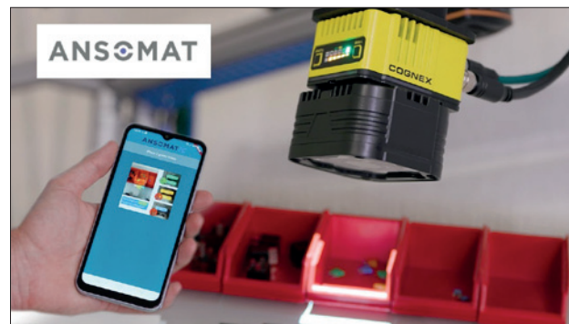
Obr. 3. Systém navádění operátorů při montáži Ansomatic využívá systém strojového vidění k detekci vykonání jednotlivých montážních operací
