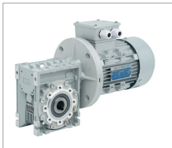
Obr. 3. Standardní šneková převodovka CM (rozsah výkonů 0,06 až 7,5 kW, rozsah momentů 15 až 1 050 N·m, převodový poměr 5 až 100) (foto: Transtecno)
