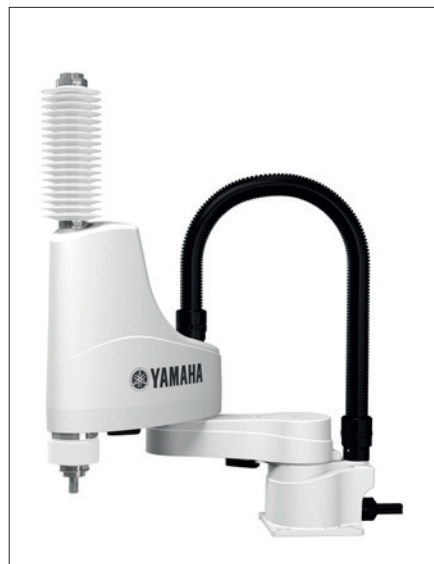
Obr. 2. Robot SCARA řady YK-XEC s úpravou pro čisté prostory (foto: Yamaha Robotics)
