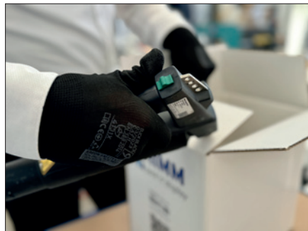
Obr. 2. Krabice se uzavírají pomocí ruční aplikáční pistole EasyStar a nové tavicí jednotky Robatech Easy (dodavatel: Kaletech)
