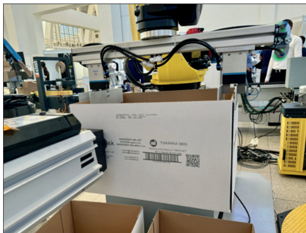
Obr. 3. Značení krabice tiskárnou Markem Imaje 5800 (dodavatel: Ondrášek Ink-Jet System)
