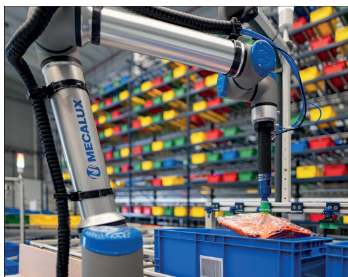
Obr. 3. Simatic Robot Pick AI určený pro šestiosé roboty, které provádějí tzv. vychystávací operace
