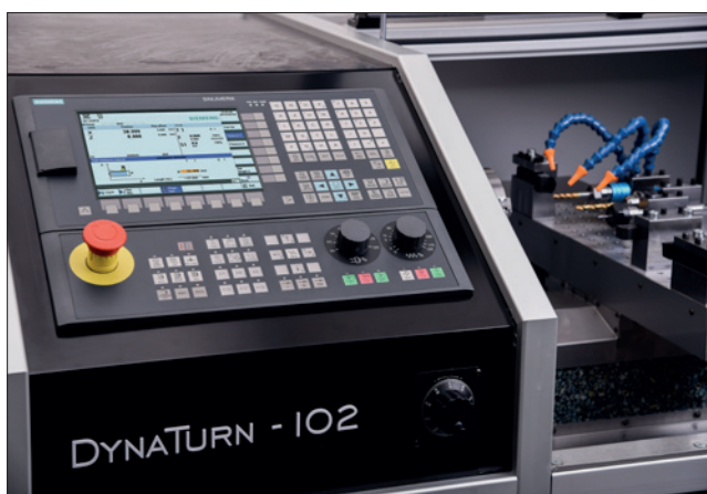
Obr. 1. Soustruh DynaTurn společnosti DynamiTech je osazen řídicím systémem Sinumerik 828D vybaveným nativním digitálním dvojčetem
