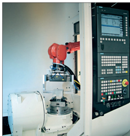
Obr. 2. Sinumerik Run MyRobot direct control umožňuje kompletní integraci kinematiky robotu do CNC
