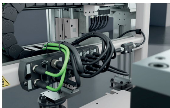
Obr. 3. Díky předem smontovaným konektorům jsou instalace a zapojení senzorů a akčních členů bezchybné a rychlé
