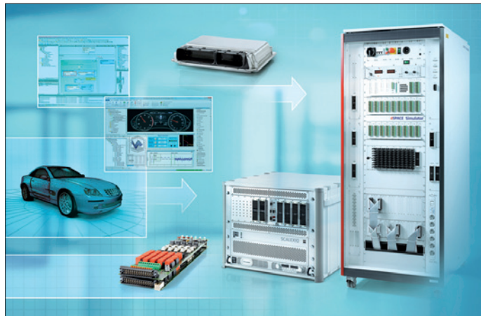
Obr. 4. Simulátory dSpace pro ověřování řídicích programů pohonů v reálném čase
