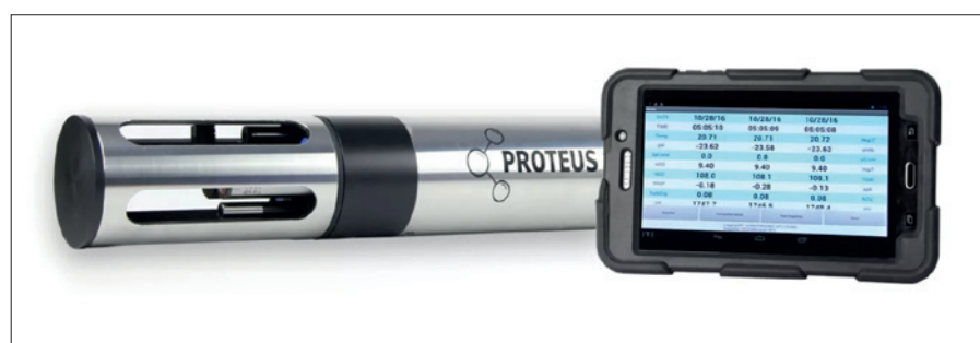
Obr. 1. Měřicí sonda kvality vody Proteus (zdroj: Novast Automation)
