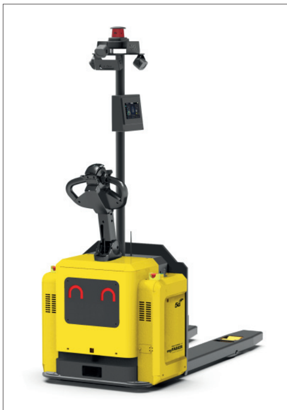
Obr. 1. Paletový vozík myFABER PalletJack F20, určený pro manipulaci v úzkých uličkách, je vhodný pro široké spektrum typů skladů s různými paletovými operacemi; automatizovaný robotický vozík se používá především k horizontální manipulaci se zbožím ve skladech pro nakládku a vykládku zboží
