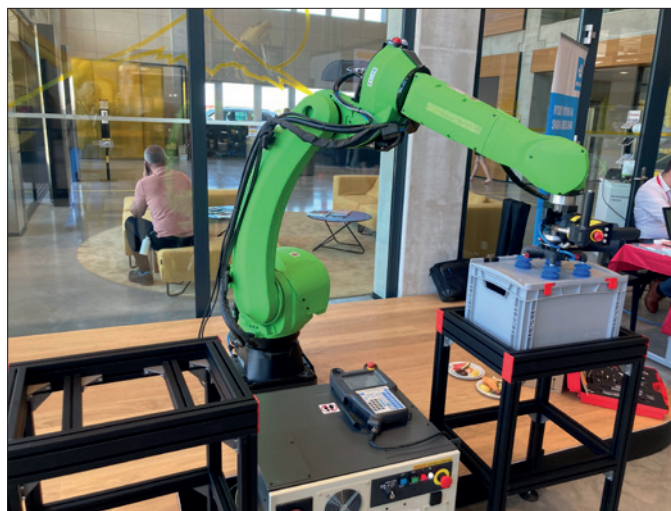
Obr. 2. Manipulaci s těžšími paletami předváděl robot Fanuc CR-35iB s nosností 35 kg a dosahem 1 831 mm
