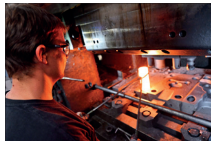
Obr. 4. Divize kovárna a kalírna vyrábí především ocelové zápuskové výkovky, a to i s komplexně členitou dělicí rovinou, s hmotností od 0,1 do 25 kg
