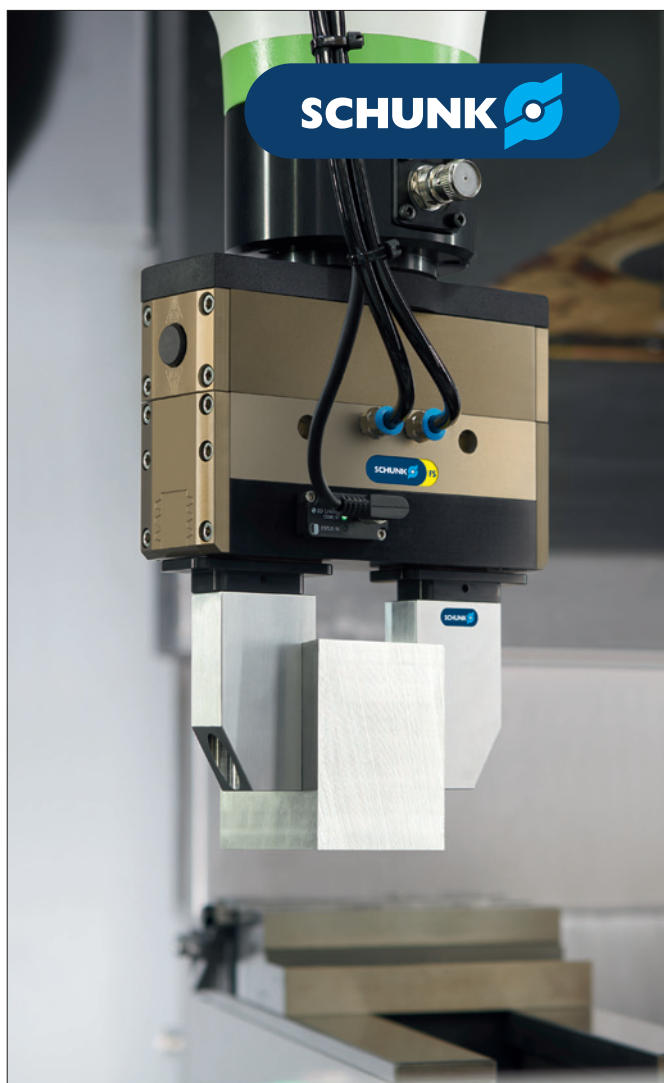
Obr. 1. Nové chapadlo PGL-plus-P má jako první pneumatické chapadlo certifikované bezpečné udržení uchopovací síly a integrované snímače s rozhraním IO-Link ( https://youtu.be/IQ6sKwE-t4o )
