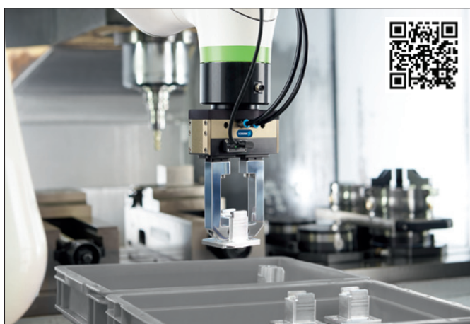
Obr. 1. Nové chapadlo PGL-plus-P má jako první pneumatické chapadlo certifikované bezpečné udržení uchopovací síly a integrované snímače s rozhraním IO-Link ( https://youtu.be/IQ6sKwE-t4o )
