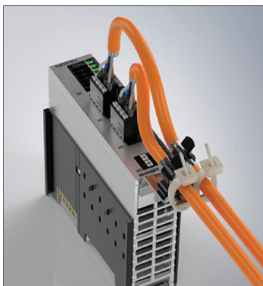
Obr. 5. Terminál ELM7222-9016 umožňuje realizovat bezpečnostní funkci STO
