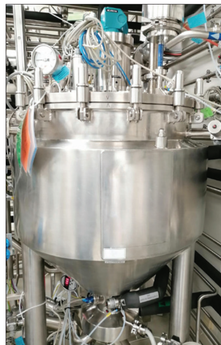
Obr. 2. Příklad farmaceutické tlakové nádoby s instalovaným snímačem PM 111 D2
