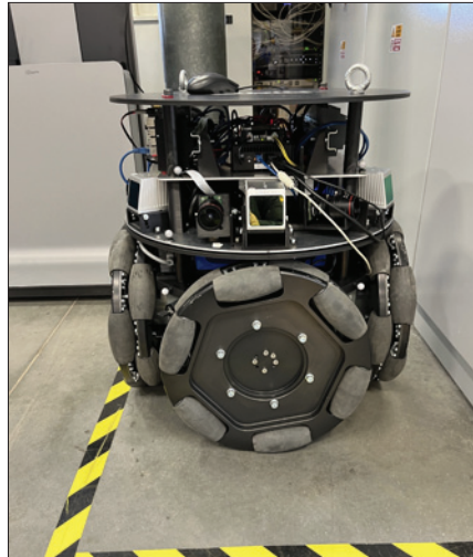
Obr. 6. Autonomní robot s všesměrovým podvozkem se dokáže pohybovat nejen v prostředí testbedu, ale i v mnohem náročnějších podmínkách
