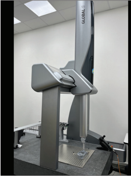
Obr. 5. Vysoce konfigurovatelný souřadnicový měřicí stroj Global S od firmy Hexagon se vyznačuje vynikající přesností a flexibilitou využití
