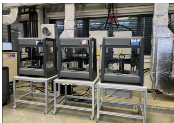
Obr. 4. Testbed je vybaven několika 3D tiskárnami DM Studio System 2+ pro tisk z kovu (na obrázku) a tiskárnou Fortus 450 mc a PolyJet J850 Prime od firmy Stratasys pro tisk z plastu
