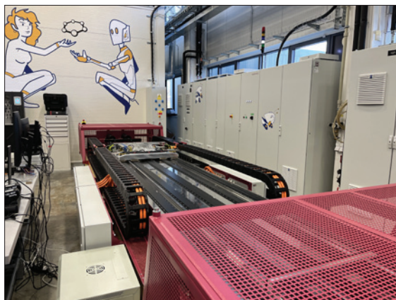
Obr. 2. Pracoviště pro testování vysoce dynamických lineárních pohonů
