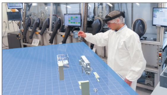
Obr. 1. Plánování rozvržení výrobních zařízení pomocí softwaru HoloLayouts s využitím minimalizovaného layoutu
