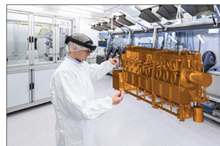
Obr. 3. Model rukavicového boxu – kontejneru, který je hermeticky uzavřený vzhledem k okolnímu prostředí a je plynotěsný (zobrazený v HoloLayouts)
