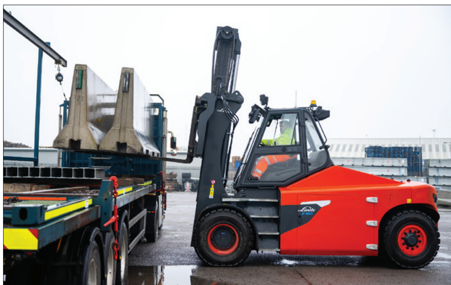
Obr. 1. Elektrické vysokozdvíhací vozíky Linde MH jsou nyní k dispozici do nosnosti 18 t
