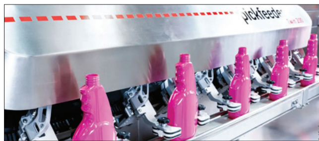
Obr. 3. Systém XTS/GFX jako součást plničky lahví; výhodou je možnost přechodu na jinou velikost lahví bez nutnosti mechanických úprav a nového seřízení, jen přeprogramováním systému ( https://youtu.be/BNM5ZZyBdeE )
