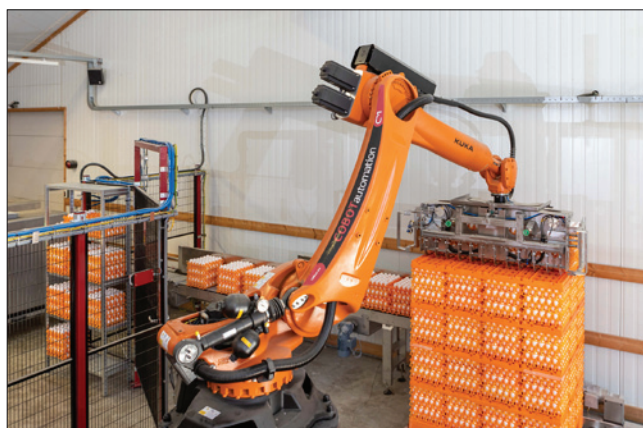
Obr. 3. Chapadlo je navrženo tak, aby si poradilo i s materiály, jako jsou lepenka a plast
