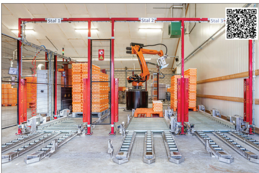
Obr. 2. Společnost Meggson zavedla kompaktní paletizační systém, který dokáže manipulovat s různými baleními vajec ( https://prod1-plate-attachments.s3.amazonaws.com/attachments/5f4c12a1d2/RB%20TP300-51.mp4 )
