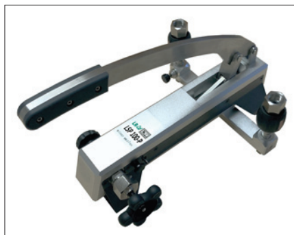
Obr. 2. Ruční pneumatická kalibrační pumpa LSP-100-P do 10 MPa
