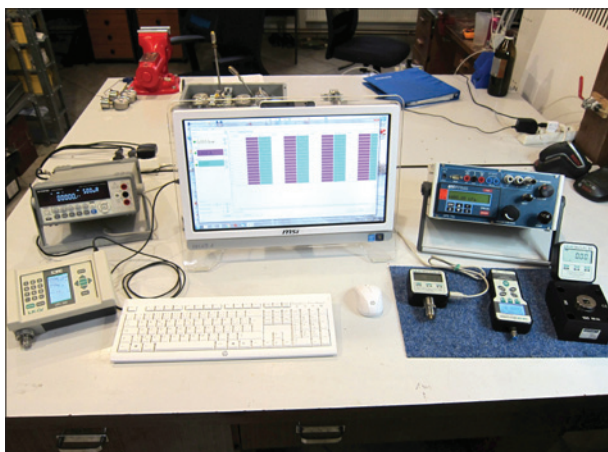
Obr. 4. Kalibrační pracoviště s etalony připravenými k měření a k záznamu dat pomocí programu LPC COM Universal
