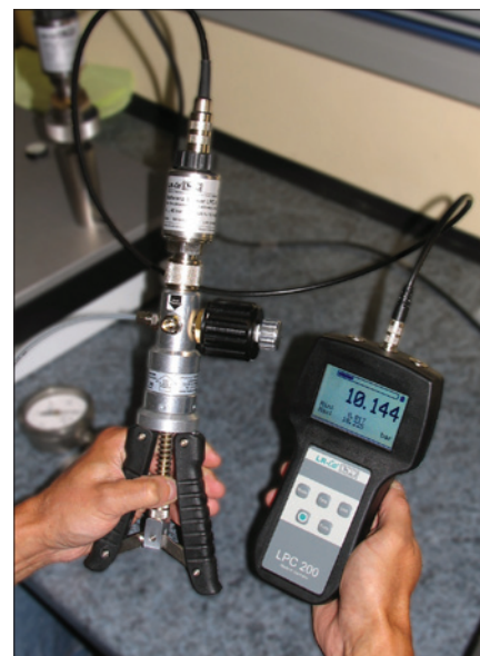
Obr. 3. Kalibrátor tlaku LPC 200 s výměnnými senzory a kalibrační pumpa LPP 40
