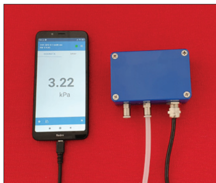
Obr. 1. Snímač tlaku řady S s připojeným mobilním telefonem a aplikací pro zobrazení měřené hodnoty a záznam dat Cressto S-logger
