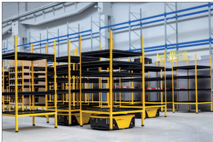
Obr. 1. S regály (racks) manipulují autonomně naváděné vozíky AGV
