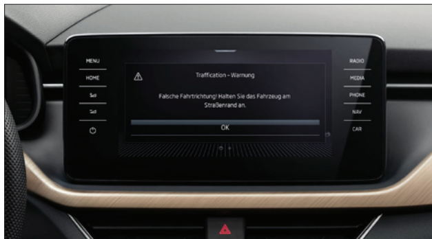
Obr. 8. Systém varování před vozidly v protisměru jako první od jara 2021 začala používat automobilka Škoda Auto
