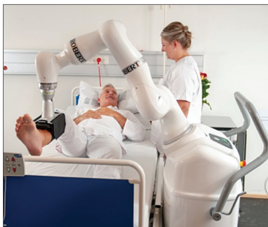
Obr. 1. Rehabilitační stroj Robert využívá lehké robotické rameno LBR Med od firmy Kuka
