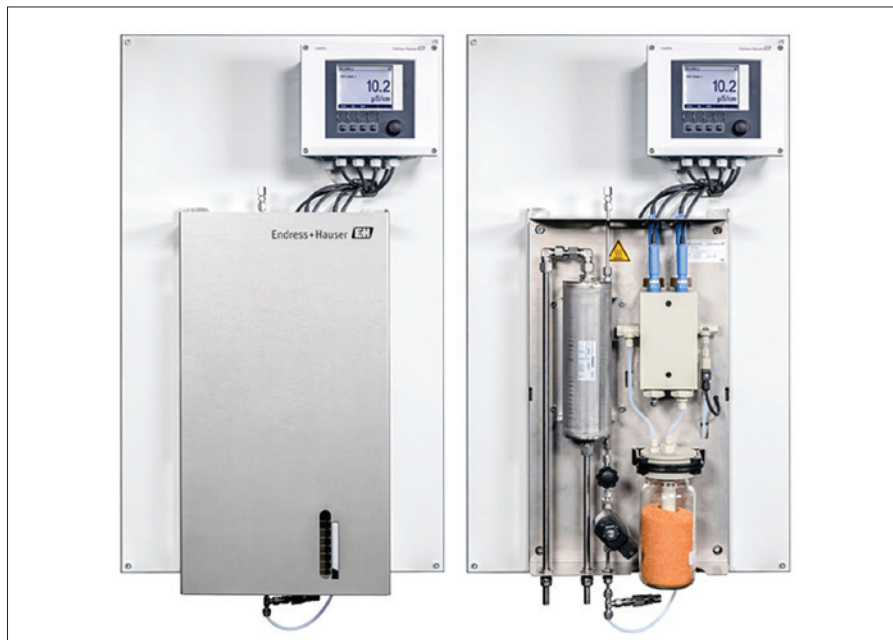
Obr. 5. Kompaktní panel SWAS CDP60 (zakrytovaný a bez krytu)
