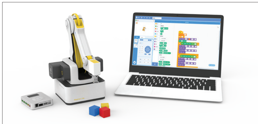
Obr. 3. Roboty Dobot Magician je možné programovat pomocí propojování funkčních bloků
