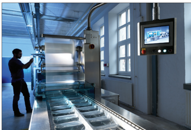
Obr. 2. Ukázková linka ve Fraunhoferově ústavu IGCV – adaptace spotřeby termobalického stroje
