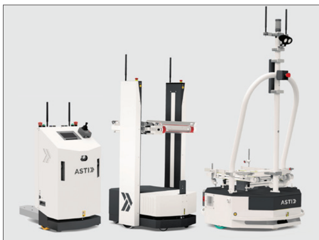
Obr. 3. V sortimentu ASTI jsou i malé AMR Boxmover, určené pro dopravu lehkých nákladů: robot vlevo má ližinu pro eurokontejnery, uprostřed je robot s krátkým dopravníkem na krabice, boxy nebo klece a vpravo je robot, který může za sebou tahat malé transportní vozíky
