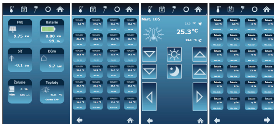
Obr. 2. Přehledová a ovládací obrazovky dostupné z aplikace iFoxTrot na platformě iOS (Apple) – zleva je přehledně aktuální spotřeba objektu, výroba FVE, nákup ze sítě, akumulace v bateriích, dále přehled zónové regulace ve všech kancelářských místnostech, stránka pro nastavení žádané teploty v každé místnosti zvlášť a nakonec přehled stavu všech 48 žaluzií individuálně ovládaných po celém obvodu budovy
