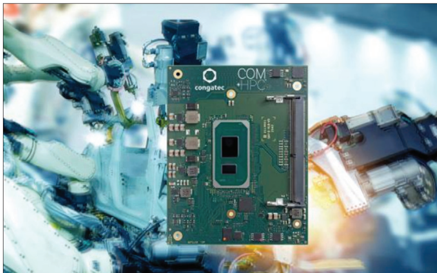
Obr. 1. Moduly COM-HPC společnosti congatec s procesory Intel Core jedenácté generace zdvojnásobují datovou propustnost díky podpoře PCIe Gen4
