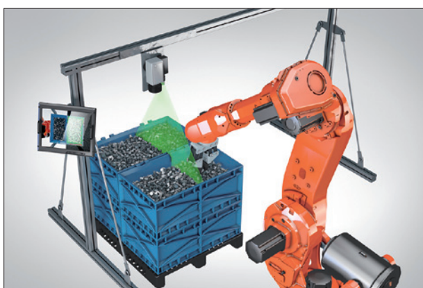
Obr. 1. Bin picking – vybírání náhodně orientovaných výrobků z bedny, je častá úloha vyžadující souhru robotu a systému strojového vidění
