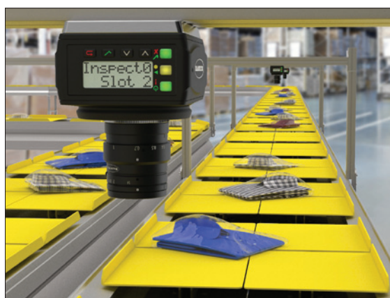
Obr. 5. Průmyslová kamera VE Smart pro vysokorychlostní třídění zboží v textilním průmyslu
