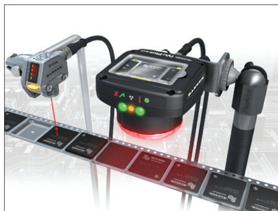
Obr. 2. Kombinace snímače obrazu iVu Plus a snímače vzdálenosti řady Q4X při měření polohy a detekci orientace integrovaných obvodů
