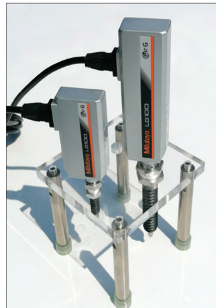
Obr. 2. Fotoelektrická měřicí sonda LG s rozsahem do 100 mm
