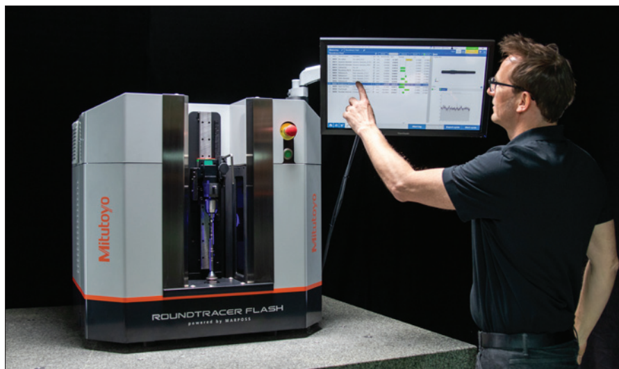
Obr. 5. Roundtracer Flash je měřicí stroj určený ke kontrole rotačních dílů
