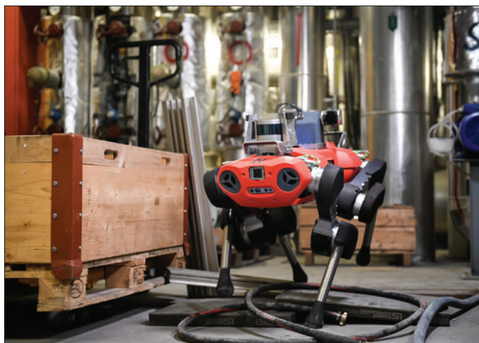
Obr. 1. ANYmal C od firmy ANYbotics je robustní robot, který je navržen pro provoz v náročném a členitém terénu, jako jsou příbřežní větrné elektrárny, ropné plošiny, doly a průmyslové provozy
